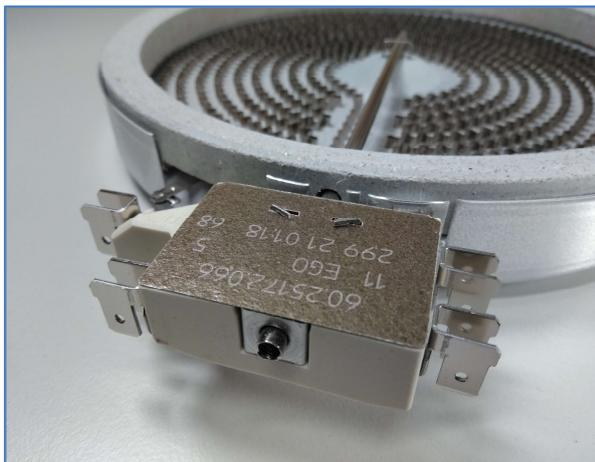
Die Anschlüsse sind als Flachsteckfahnen mit 6,3mm ausgeführt, Doppelsteckfahnen nach unten abgehend.
